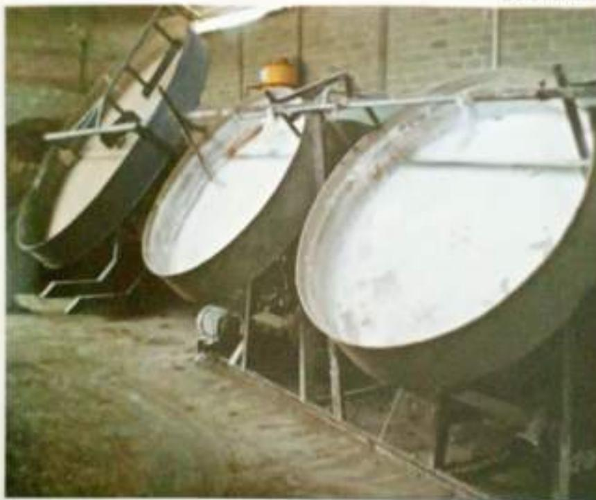
**Mesin piringan granulator.** Memiliki ukuran diameter yang bervariasi
