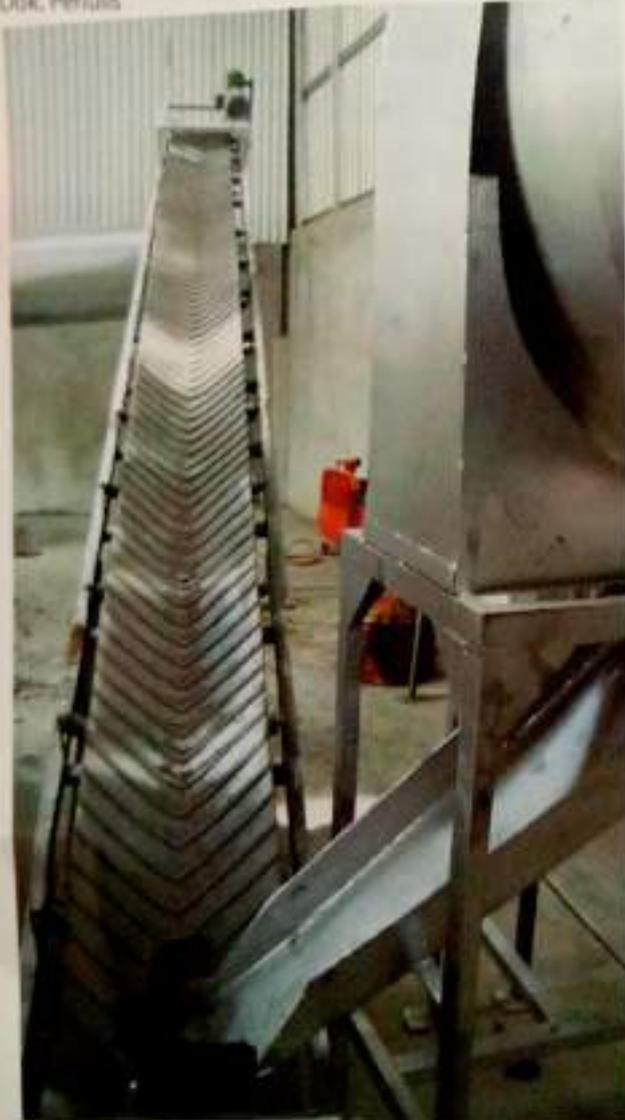
Keberadaan konveyor tergantung dari desain proses produksi pupuk organik granul. Konveyor dapat diletakkan antara piringan granulator dengan *rotary dryer* untuk memindahkan granul kompos yang akan dikeringkan. Konveyor dapat pula digunakan sebagai pelengkap mesin pengayak untuk memindahkan hasil ayakan pupuk organik granul sehingga tidak
