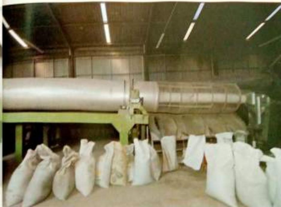
**Gabungan rotary drier dengan mesin pengayak.** Dilakukan untuk menghemat energi yang digunakan
