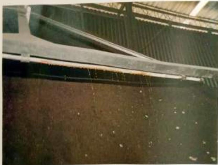
**Penyemprotan larutan molase.** Dilakukan selama proses granulasi dengan menggunakan *sprayer*
