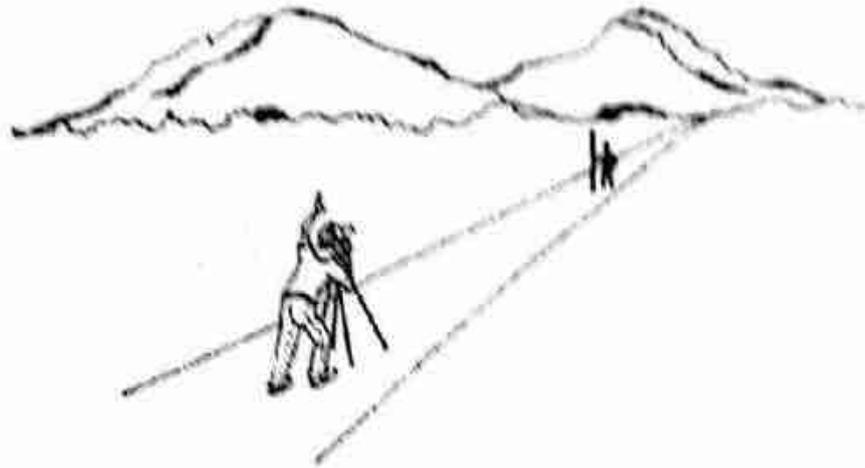
**Gambar 5.** Cara pemetaan dengan menggunakan teodolit.
